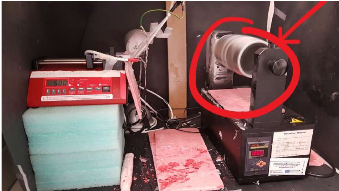
Imatge 41. Senyalització del recol·lector cilíndric a l'equip d' electrospinning . Font: pròpia
