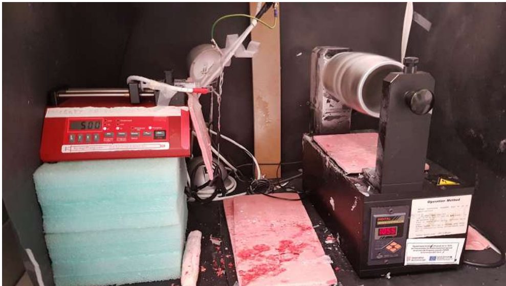
Imatge 25. Equipació d'electrospinning utilitzat durant l'estança al PCB. Font: pròpia.
